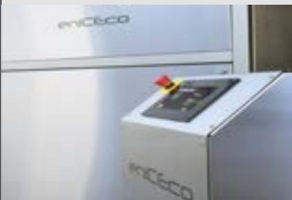
La estructura de acero inoxidable está diseñada para que se pueda mover fácilmente con un transpalet, lo que facilita una limpieza regular y fácil. Los paneles extraíbles grandes brindan un amplio acceso a todas las piezas dentro de la pelletizadora y hacen que el mantenimiento de rutina sea fácil. Se accede al control del pelletizador desde la pantalla táctil.
